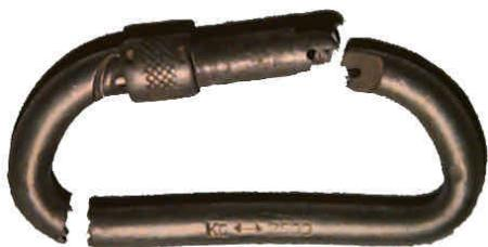
2) Même type que 1) avec une corrosion prononcée du bout du doigt.
