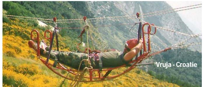
Très utilisée dans les Balkans et les Alpes orientales, cette civière se divise en 2 éléments pour son portage. Une roue peut s'adapter sous son châssis. Bien qu'encombrante, elle est d'un poids raisonnable et reste manœuvrante.
