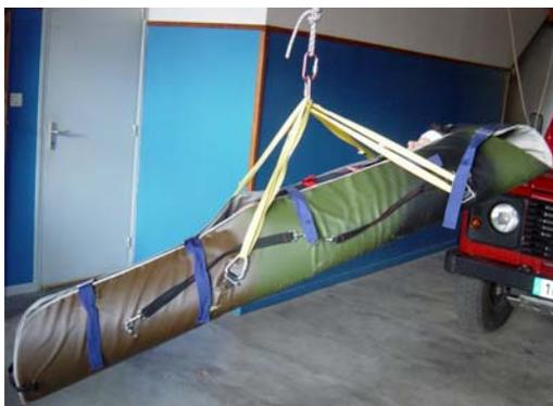
La civière ATC, de type gouttière, assure une protection de la victime remarquable. Son enveloppe est renforcée à l'intérieur par des boudins amortisseurs qui protègent le tronc de la victime. Celle-ci est immobilisée par un matelas immobilisateur à dépression qui assure un maintien efficace de l'axe tête-cou-tronc. Conditionnée, cette civière possède une très bonne rigidité.
