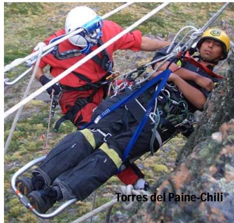
Civière entièrement démontable et permettant un relevage de victime selon le principe de la civière à aubes. Elle autorise toutes les positions de progression. Le système de pantoire est mal conçu. Cette civière est du reste inconfortable pour la victime et fragile. Son châssis est trop étroit et le corps de la victime est exposée sur toutes ses faces aux frottements ou autres chocs.
